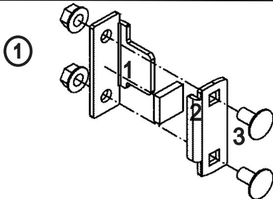
Tope metálico: Pege el adhesivo 2 por medio de 1 y 3. Es importante montar el tope metálico antes de activar el motor. Deje los tornillos flojos para después poderlo introducir en la guía y moverlo hasta un punto deseado.
