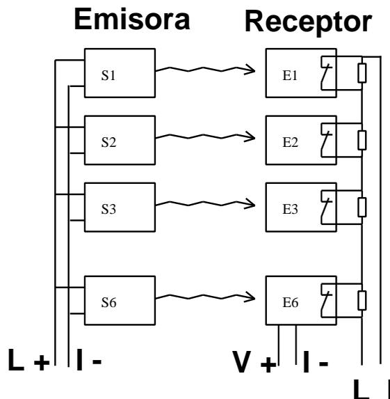
Al cuadro electrónico se pueden conectar y comprobar hasta 6 barreras de luz. Para eso se conectan todas las salidas de los relés del receptor en serie. Paralelamente hay que conectar una resistencia de 1 kOhm +/- 5% a todos los contactos de los relés de cada receptor.
