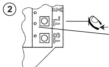
Pulsar **TL** durante 5 seg. hasta que LED **rojo** quede encendido permanentemente. Ahora pulsar **TL** 3 veces brevemente hasta que LED **rojo** y **amarillo** queden encendido permanentemente.
