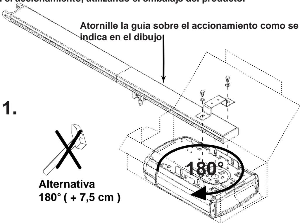
Ajuste los tornillos con una llave N° 10. Observe los pasos dados en el dibujo.
